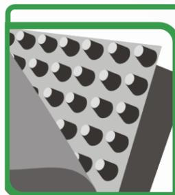
Geodrenes o Geocompuestos de Drenaje son productos geosintéticos prefabricados con un núcleo de poliestireno de alto impacto en forma de columna. Estos facilitan la conducción de fluidos al crear un área hidráulica. A diferencia de sistemas tradicionales, se fabrican con precisión para cumplir normas ASTM, asegurando que el flujo de agua en el proyecto se ajuste a lo planeado.
