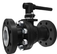
Válvulas de bola flotante diseñadas para plataformas petroleras, con cuerpo atornillado o soldado, según ASME B16.34. Incluyen opciones de placas difusoras de calor y materiales resistentes para servicio NACE. Cumplen con API-607 a prueba de fuego y pruebas de presión según API 598.
