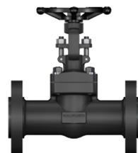
Válvulas de compuerta, globo y retención tipo columpio, pistón y bola conforme a API-602, con diseño en "T" o "Y" para globo y retención. Disponibles con extremos soldables, roscados o bridados, bonete soldado o bridado, y opción criogénica. Tamaños de 1/4" a 2", clases de presión de 150# a 2500#, y pruebas según API-598.
