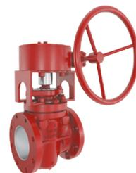
Las válvulas de cierre rápido están diseñadas conforme a API-599 y MSS-SP-78, con balanceo mecánico por resorte para evitar el atasco del tapón. Pueden ser operadas con palanca o engranaje y son bidireccionales, con opciones de bloqueo por candado, extensiones, elevaciones y sellante WALSEAL, además de cumplir con las pruebas de presión según API 598 y MSS SP-78.
