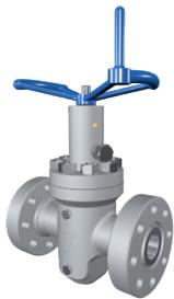
Válvula bidireccional conforme a la norma API-6A, con paso completo y continuo, y sello dual suave y metal-metal, hermético y de activación mecánica. Opciones de recubrimiento en Carburo de Tungsteno, Carburo de Cromo y Stellite-6. Cuenta con empaques tipo "V", re-empaque del vástago bajo presión y caja de rodamiento para reducir torque. Disponible en tamaños de 2-1/16" a 7-1/16" y presiones de 2000 a 5000 PSI, en clases de material AA a FF.
