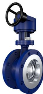
Las válvulas de mariposa con sello resiliente y epóxico interior están disponibles en estilos Wafer, Lug o Ranurado. Ofrecen operación manual, por engranajes o automatizada, con sellos suaves de EPDM, neopreno o NBR. Sus pruebas de presión cumplen con API-598, y se fabrican en tamaños de 3" a 24" con presiones de hasta 362 CWP.
