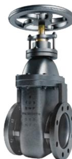
Las válvulas para servicios generales, disponibles en diseño OS&Y o NRS, operan con volante o engranajes. Pueden incluir accesorios como vástagos extendidos y contrapesos en modelos de retención. Cumplen con pruebas de presión API-598 y tamaños de 2" a 36".
