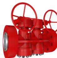
Válvulas Macho de acero lubricadas tipo compensador (Tapón Invertido) cumplen con API-6D, con diseño bidireccional y balance dinámico para evitar atascamientos. Disponibles con extremos RF, RTJ o BW en tamaños de 2" a 26" y clases de presión de 150# a 2500#. Operación manual o automatizada, con pruebas de presión según API-6D y sellante WALSEAL para diversas aplicaciones.
