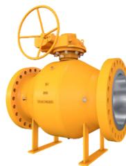
Diseño de entrada lateral con cuerpo atornillado o soldado, paso completo o reducido y opciones de sello suave o metal-metal con recubrimientos especiales. Cumple con API-6D, API-6FA y API-607, con opciones de operación manual o automatizada. Disponible en 2" a 60" y clases de presión de 150# a 2500#, con extremos RF, RTJ o BW.
