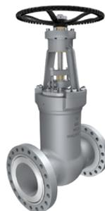
Válvulas de sello a presión (Pressure Seal) de compuerta, globo, stop check, globo diseño en "Y", retención tipo columpio, tilting disc check y lift check según ASME B16.34. Disponibles en tamaños de 2" a 24", con clases de presión de 600# a 2500#. Operación manual o automatizada, con opciones de amortiguador y contrapeso, pruebas según API 598 y accesorios como derivaciones e inyectores de grasa.
