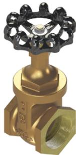
Las válvulas diseñadas según MSS-SP-80 tienen bonete roscado o tuerca unión, con opción de vástago saliente o fijo. Los extremos pueden ser roscados o soldables, y son operadas por volante. Están disponibles en tamaños de 1/4" a 2" con presiones de 125 y 150#.
