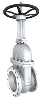
Válvulas de compuerta conforme a API-600, con obturador sólido, flexible o de disco paralelo. Disponibles para servicios criogénicos según BS-6364 y en versiones de globo (API-623) y retención (API-6D y API-594 Tipo B). Tamaños de 2" a 72" y clases de presión de 150# a 2500#, con extremos RF, RTJ o BW. Operación manual o automatizada, con pruebas hidrostáticas y neumáticas según API-598.
