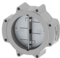
Válvulas de retención tipo Dual Plate, diseñadas según API-594, con cuerpo compacto y resorte patentado para cierre suave. Ofrecen un sello hermético con asientos metal-metal y son resistentes a la corrosión. Pruebas de presión según API 598.
