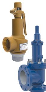
Las válvulas de seguridad y alivio están diseñadas para aplicaciones de gas, vapor y líquidos, con extremos roscados o bridados conforme a ASME. Su rango de presión varía de 15 a 5000 PSI, y ofrecen alta capacidad de liberación, con interiores en acero inoxidable. Los diseños incluyen opciones convencionales, fuelladas, con sellos suaves o metal-metal, adaptándose a las necesidades específicas de cada cliente.
